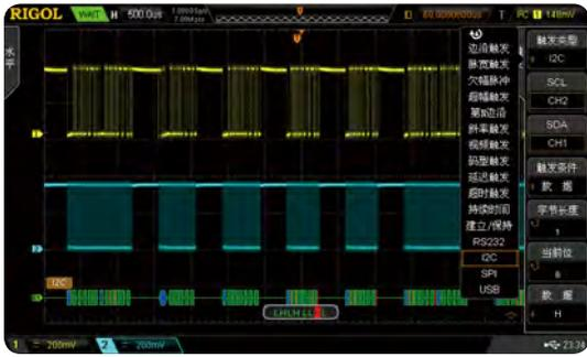
欠幅脉冲触发功能
