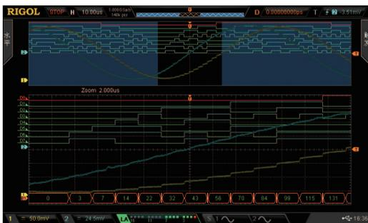
多达2+16个通道，模拟和数字通道间可相互触发，时间相关的模拟和数字通道波形显示和分析。
